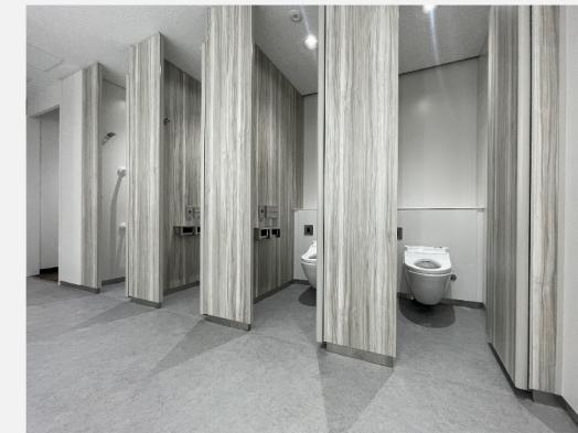
大便器は、床の清掃性と節水性に配慮した、壁掛大便器セット・フラッシュバルブ式を選定。BCP対策のひとつとして、停電時に水を流せるように停電時洗浄レバーを採用
