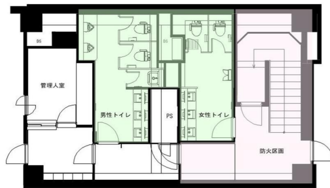
1Fテナントの変更により、男女トイレの増床が求められた。防火区画の見直しと、ゴミ集積所の有効活用でトイレスペースを拡大している。
